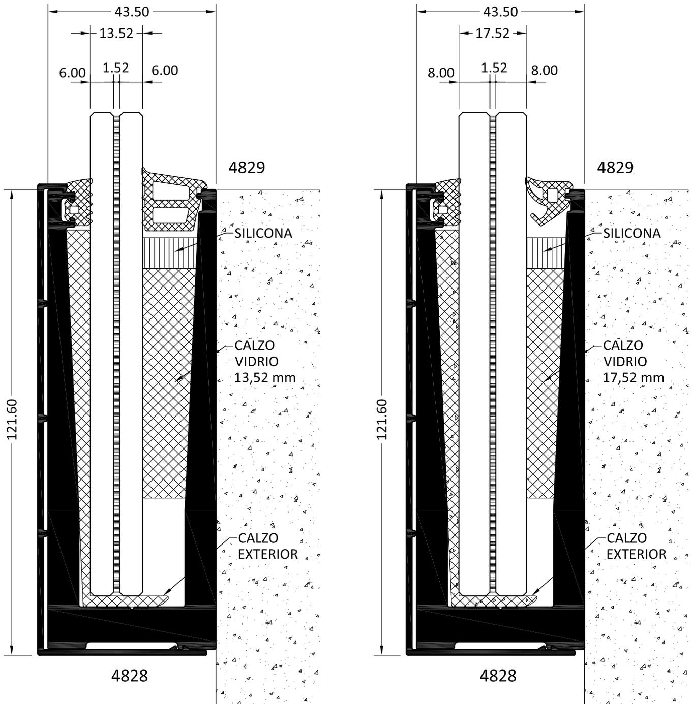
SE PUEDE SERVIR EL PERRFIL MECANIZADO (MECANIZADO TIPO 2)
