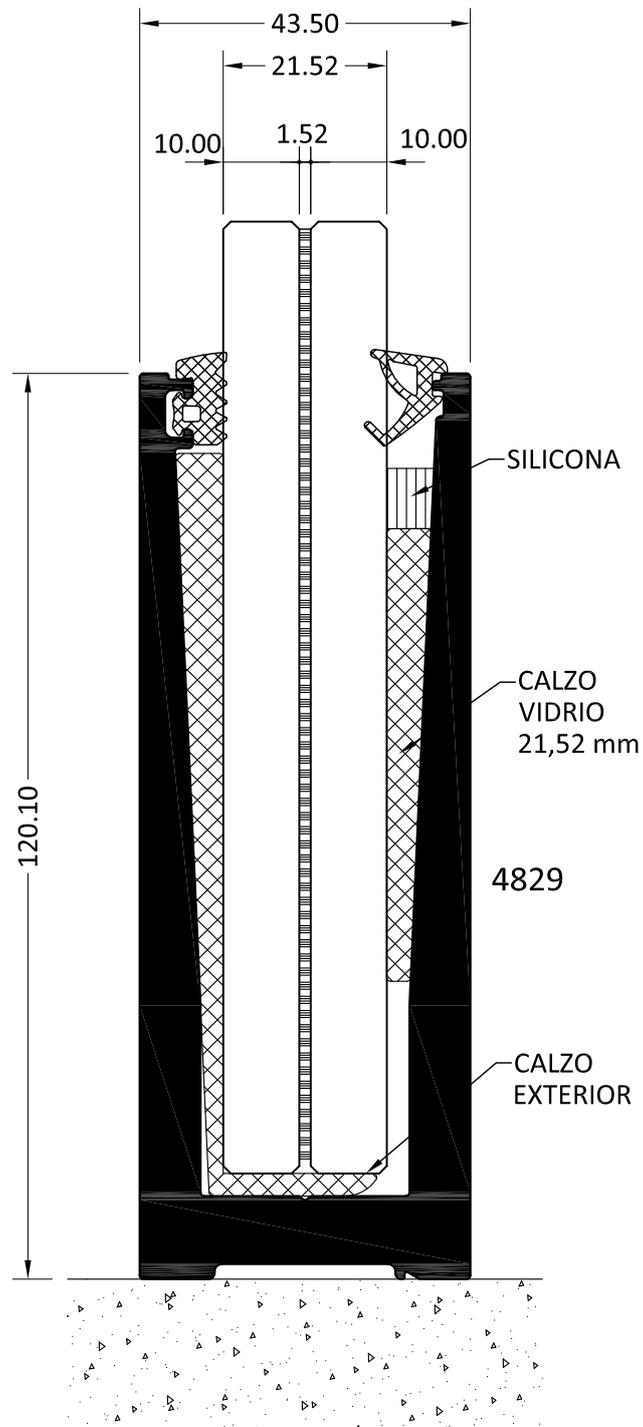
SE PUEDE SERVIR EL PERRFIL MECANIZADO (MECANIZADO TIPO 1)
