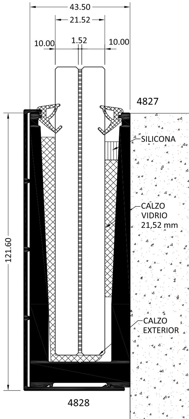
SE PUEDE SERVIR EL PERRFIL MECANIZADO (MECANIZADO TIPO 2)
