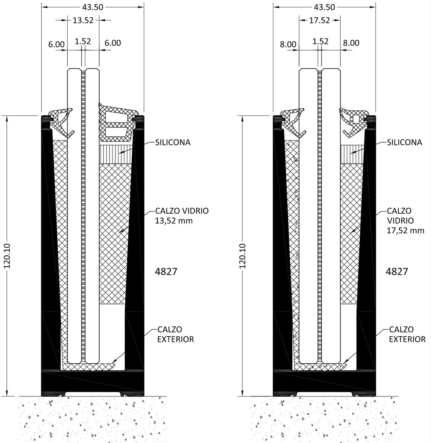
SE PUEDE SERVIR EL PERRFIL MECANIZADO (MECANIZADO TIPO 1)
