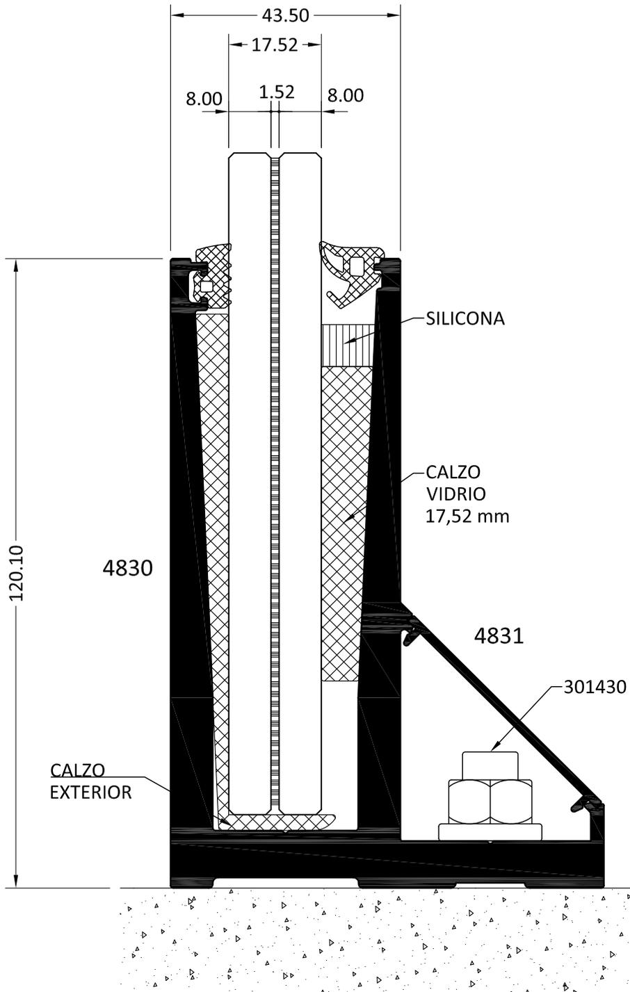
SE PUEDE SERVIR EL PERRFIL MECANIZADO (MECANIZADO TIPO 1)
