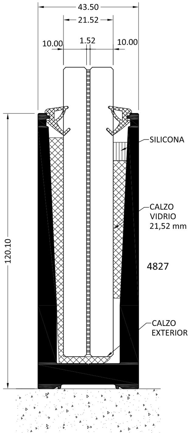
SE PUEDE SERVIR EL PERRFIL MECANIZADO (MECANIZADO TIPO 1)
